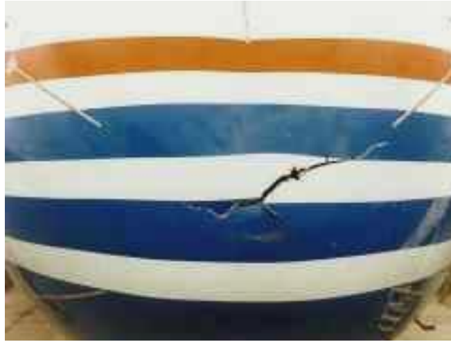
Şekil 3.3 Yönlendirici çubuk bulunmayan radomdaki yıldırım hasarı [16].
