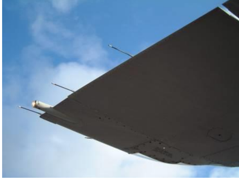
Şekil 2.6 Bir uçak kanadındaki statik boşalma uçları (static discharger) [15].
