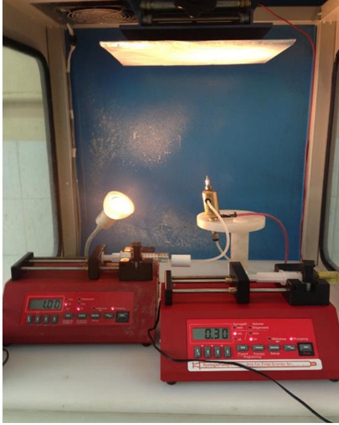
Şekil 3.1: Eş eksenli elektro döndürme düzeneğinde nanolif üretimi.
