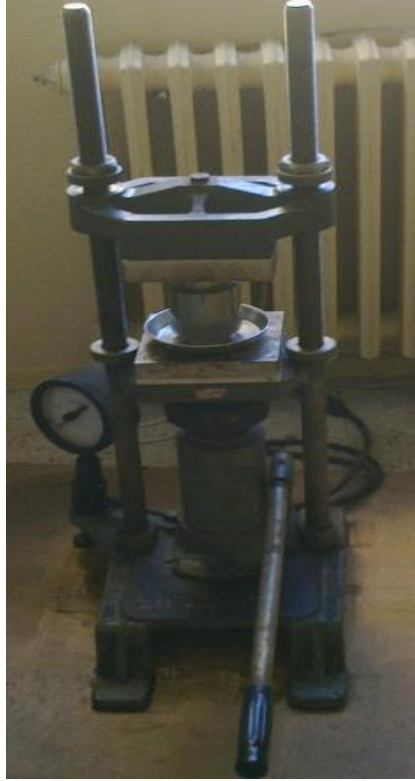
Şekil 3.3 : Çalışmada kullanılan hidrolik pres.
