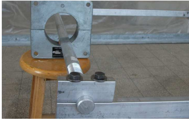
Şekil 5.18 : Porseleni çıkarılmış 1000 A'lık normal alüminyum tijli geçit izolatörünün deney düzeneği.
