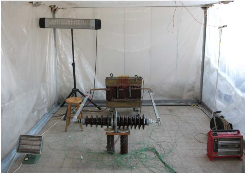
Şekil 5.16 : 1000 A alüminyum tij'li geçit izolatörünün ısıl kısa süreli akıma dayanımının doğrulanması deneyi için kurulan deney hücresi.
