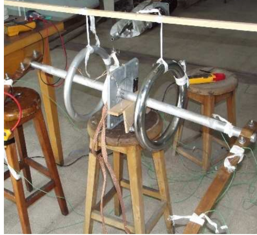
Şekil 5.20 : Aynı düzleme dizilmiş alüminyum halka, 2 paralı döküm flanş ve demir halkadan oluşan deney düzeneği.
