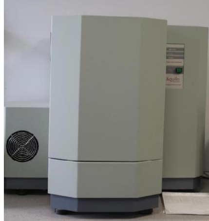
Şekil 3. 5 : İTÜ ince film araştırma laboratuvarında bulunan Aquila Instruments model NKD 7000 - Optik Ölçüm ve Analiz Cihazı.
