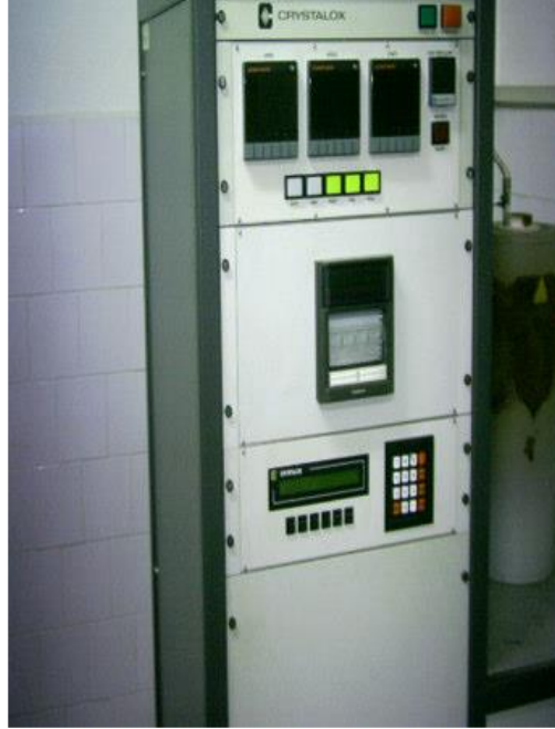
Şekil 3. 1 : Orta Doğu Teknik Üniversitesi fizik bölümü kristal büyütme laboratuvarında yer alan dikey Bridgman-Stockbarger sistemi.
