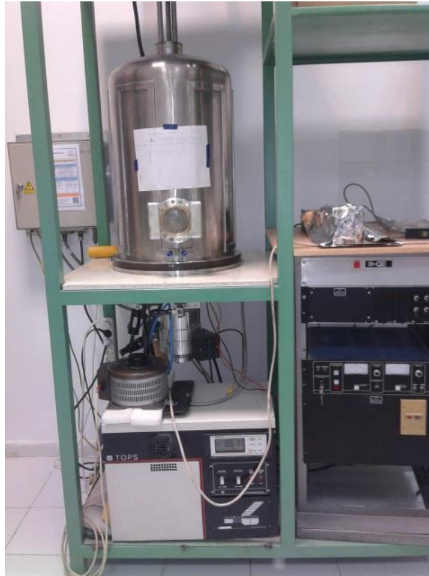
Şekil 3. 3 : Odtü Fizik bölümünde bulunan elektron demeti buharlaştırma sistemi [20].
