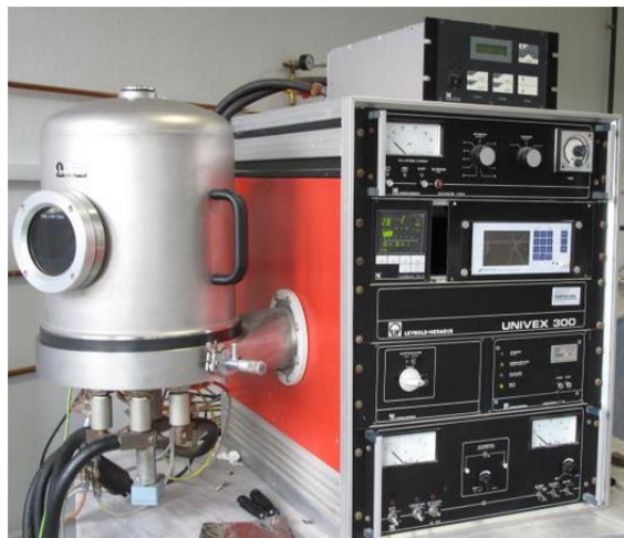
Şekil 3. 2 : İstanbul Teknik Üniversitesi (İTÜ) fizik mühendisliği bölümü ince film araştırma laboratuvarında bulunan Leybold-Heraeus / Univex 300 model ısısal buharlaştırma cihazı.
