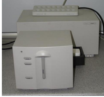
Şekil 3. 4 : İTÜ ince film araştırma laboratuvarında bulunan Agilent - 8453E model UV-VIS fotospektrometre.
