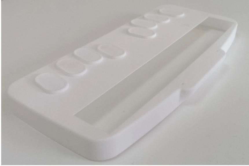
Şekil 5.54 : 3 boyutlu yazıcı ile üretilmiş ilk kabuk örneği (© Bera Başkurt, 2014).
