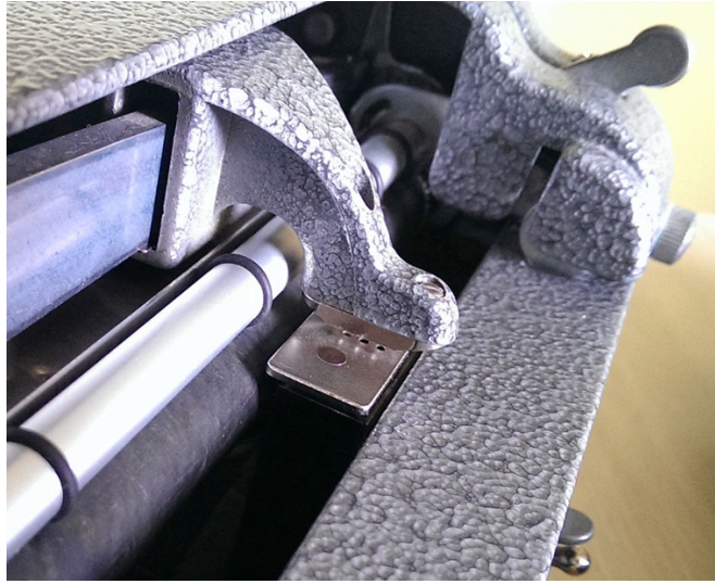
Şekil 5.5 : Braille daktilosunda bulunan kağıt üzerinde kabartma oluşturma mekanizması (© Bera Başkurt, 2015)
