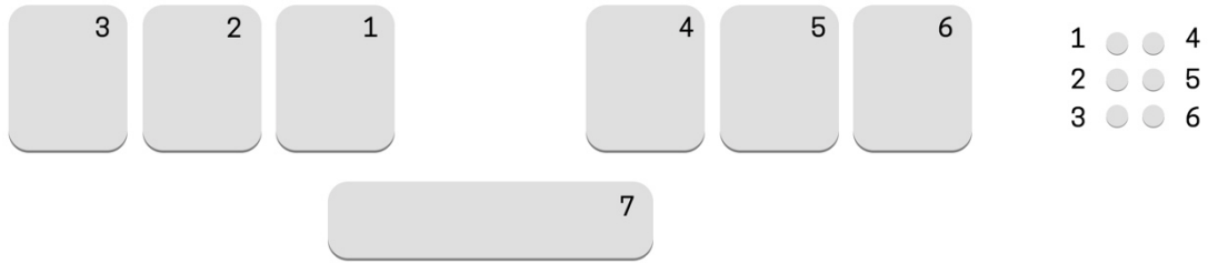
Şekil 5.45 : Perkins tipi tuş dizilimi ve Braille nokta kodlaması.
