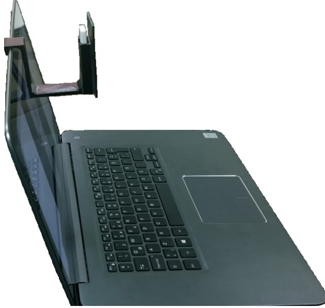
Şekil 3.7 : Genel tutucunun dizüstü bilgisayardaki yerleşimi.
