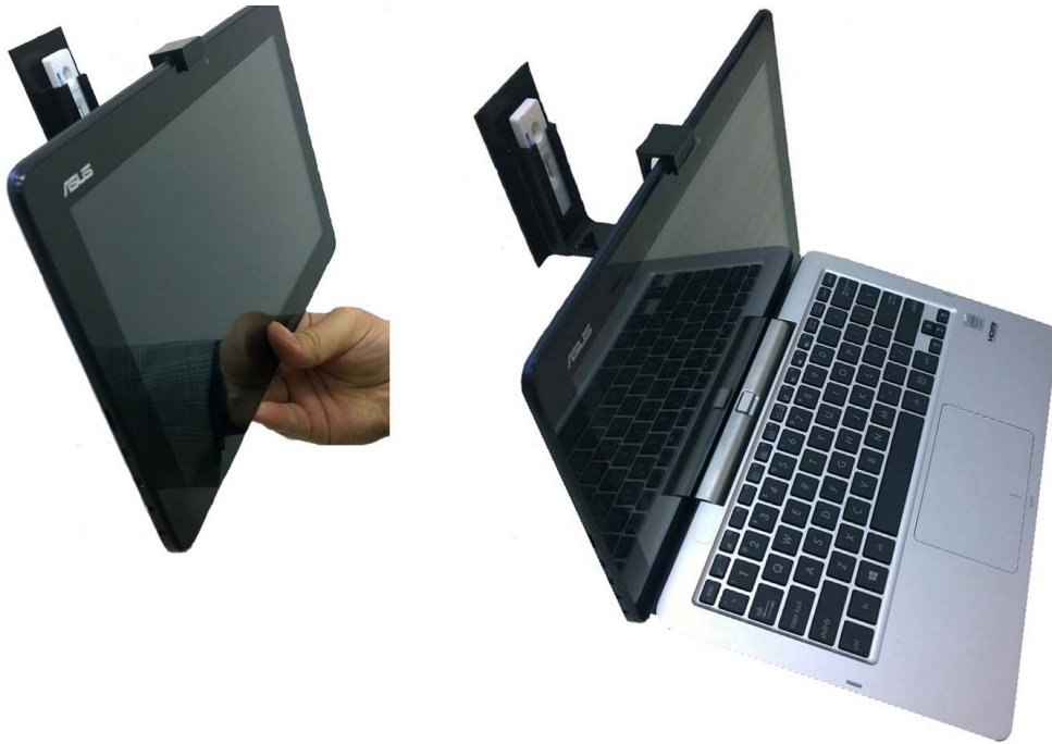
Şekil 3.6 : Genel tutucunun tablet ve ikisi bir arada bilgisayardaki yerleşimi.
