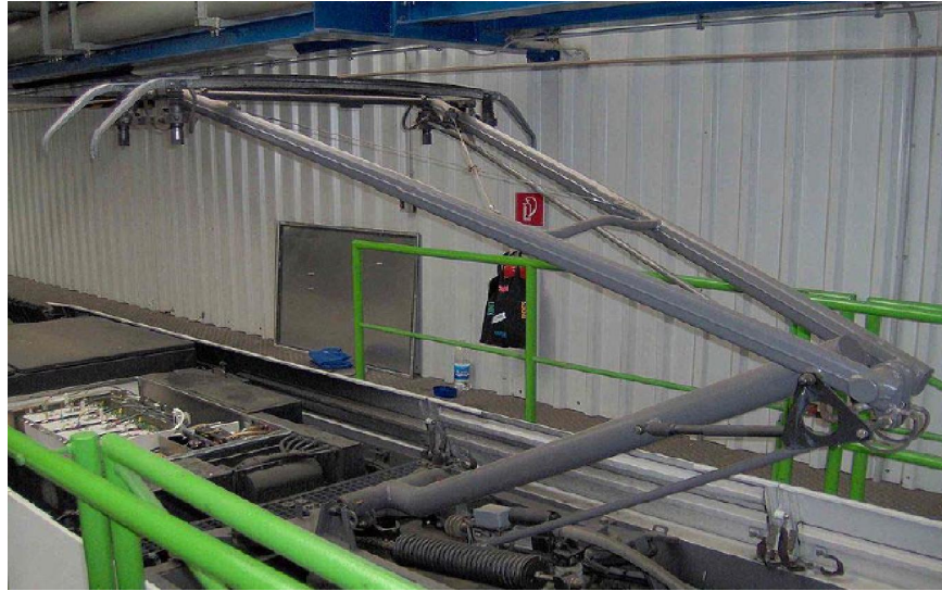
Şekil 3.2 : Z biçimli (asimetrik) modern bir pantograf [1].
