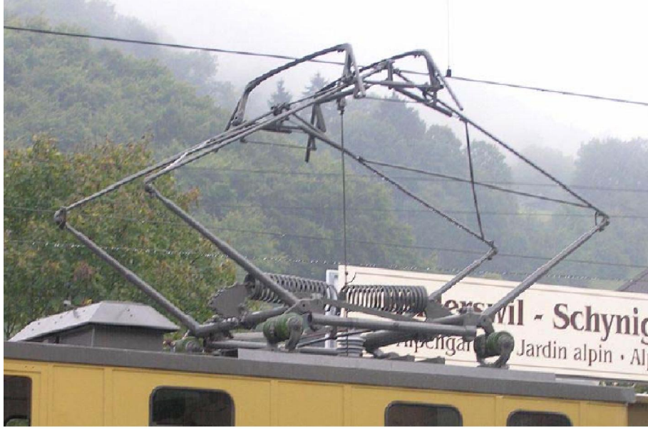
Şekil 3.1 : 1911 yılında yapılmış elmas biçimli bir pantograf [1].
