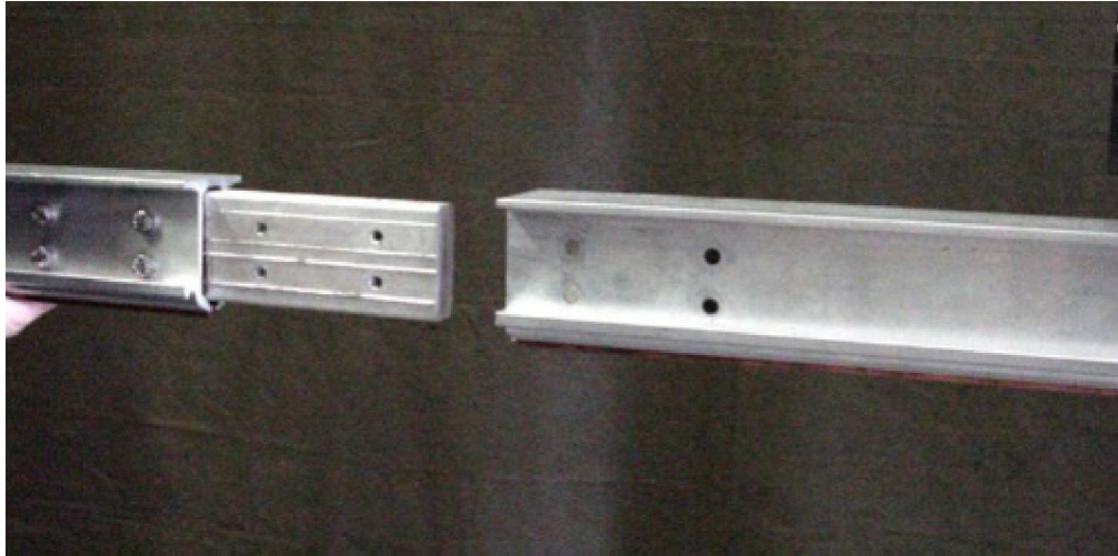
Şekil 5.5 : Ara kilitte kullanılan bağlantı çifti [10].
