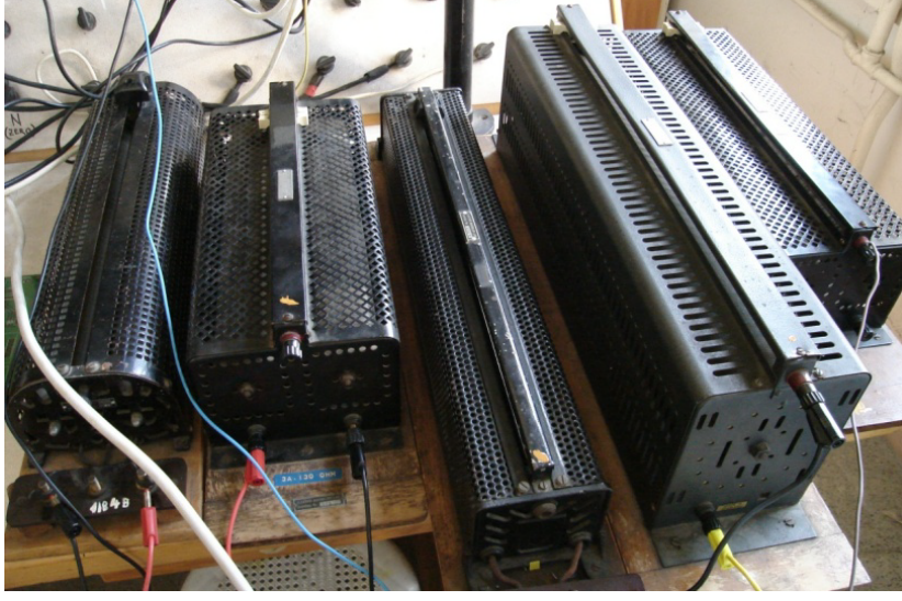
Şekil B.4: Baz istasyonu sistemini temsil eden direnç yükü grubu.
