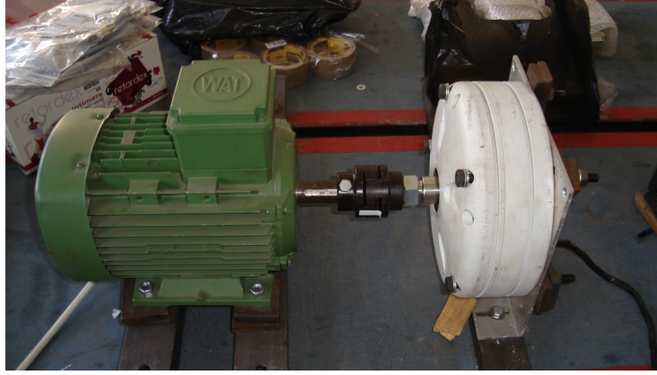
Şekil B.2: Rüzgar türbini sistemini temsil eden üç fazlı asenkron motor ve üç fazlı senkron generatör.
