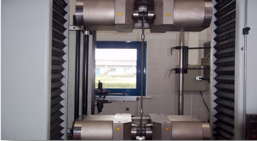
Şekil 2.6 : Çelik Halatın Çekme Testi
