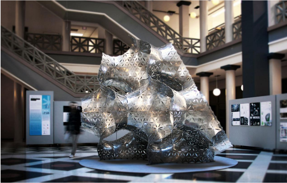
Şekil 4.18 : Houston Üniversitesi'nde kurulan 2368 adet lazer kesim alüminyum parçadan oluşan 4mt'lik model (Tenu, 2011a)
