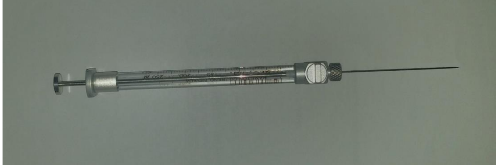
Şekil 4.7 : Sızdırmaz gaz şırıngası (gastight syringe).
