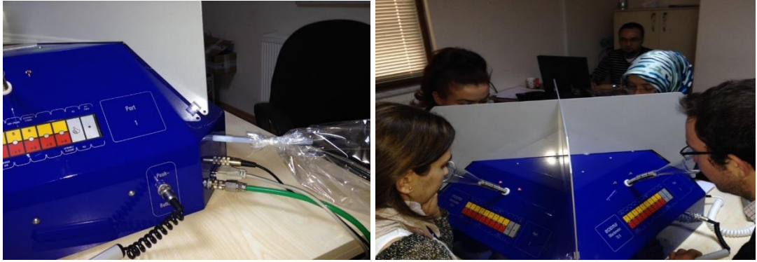
Şekil 2.9 : TO 8 Olfaktometre cihazı ve 4 kişilik panelist grubu ile olfaktometrik koku ölçümü.
