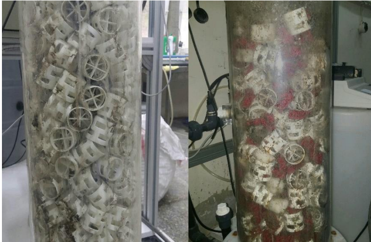
Şekil 4.3 : Dolgulu kolonda yapılan modifikasyon.
