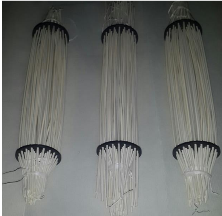
Şekil 3.16 : Boşluklu fiber (hollow fiber) membranların dizilimleri.
