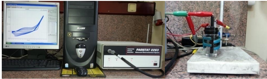
Şekil 3.2 : Elektrokimyasal polimerleşmede kullanılan potansiyostat ve hücre.
