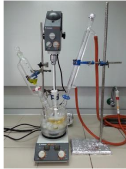
Şekil 3.4 : Reçine sentez düzeneği.
