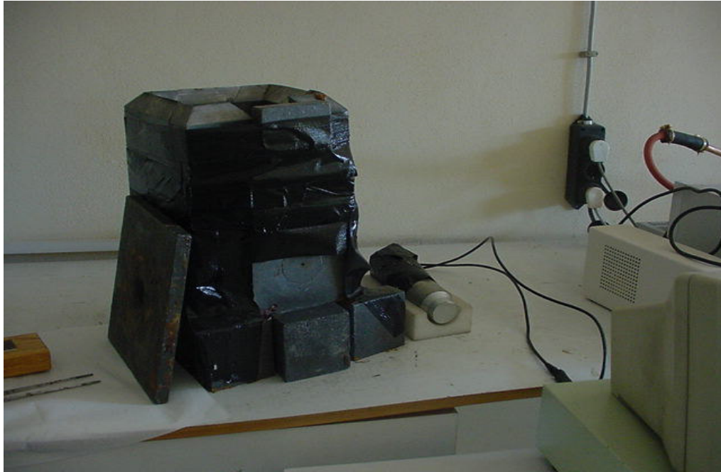
Şekil 4.18: Sayımda Kullanılan NaI(Tl) Sintilasyon Detektörü ve Kurşun Hücre
