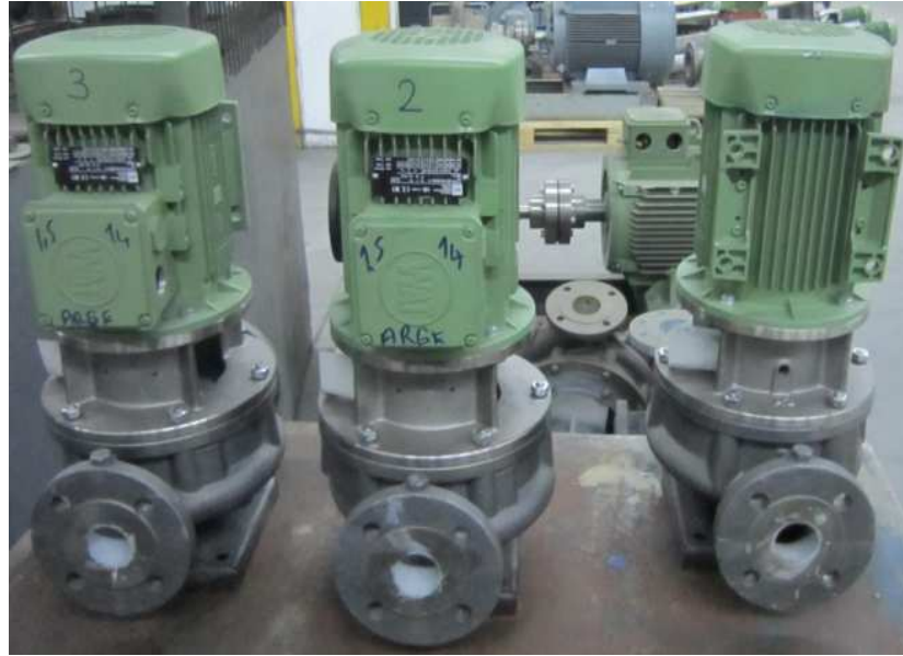
Şekil 6.3 : 3 adet SNL 40-160 santrifüj pompa
