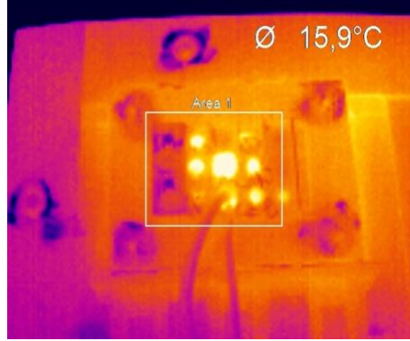
Şekil 4.19 : Termal kamera ile ısı kaçak testi.
