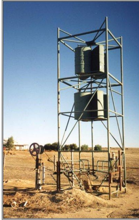
Şekil 2.14 : Su pompalamak için kullanılan el yapımı Savonius rüzgar türbini (Url-4).
