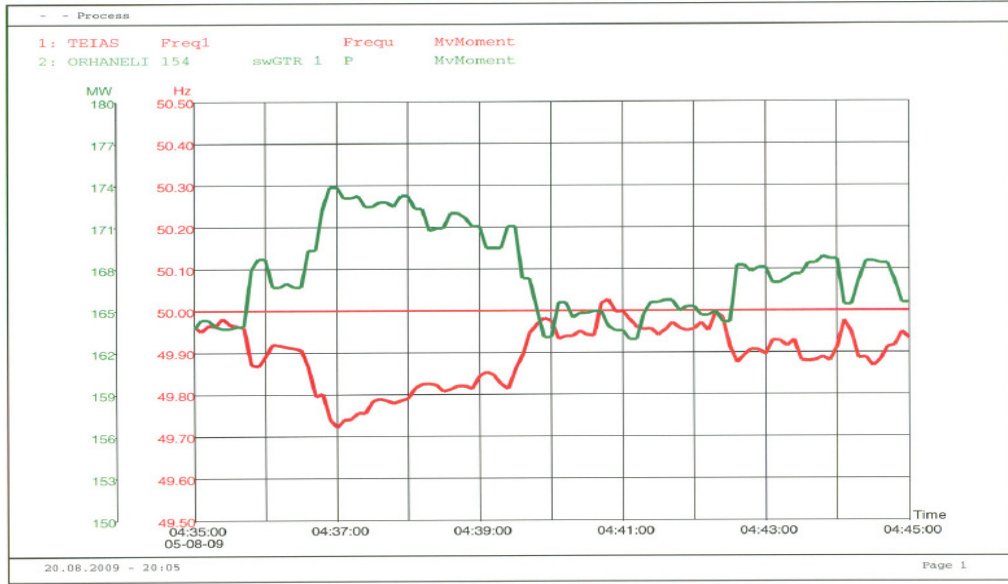
Şekil 6.19: Primer Frekans kontrolüne katılan bir ünitenin çıkış gücü grafiği [1].
