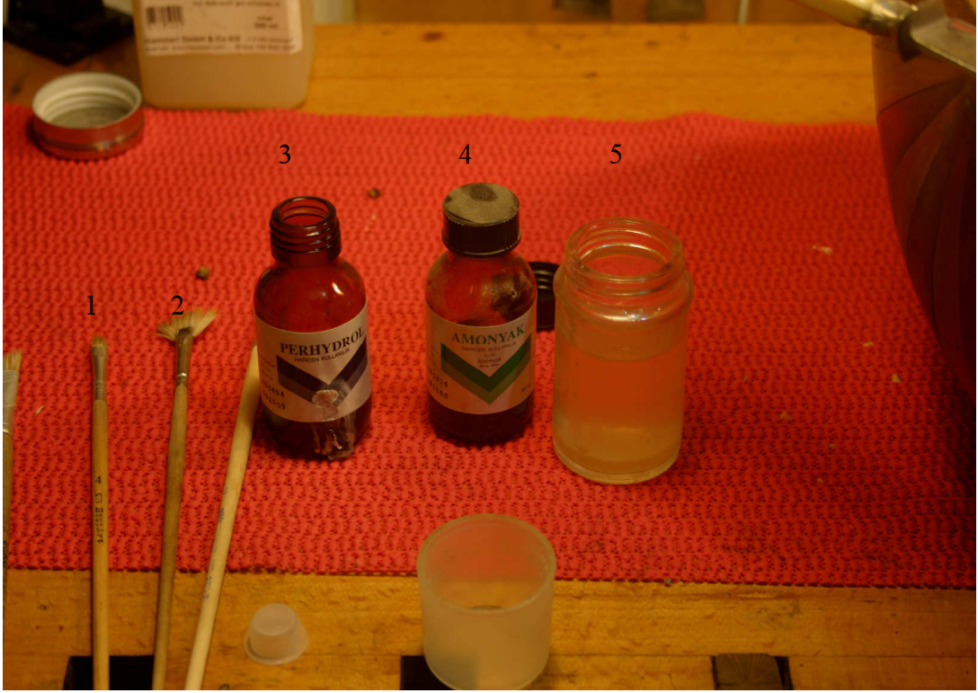
Şekil 3.1 Çatlakları düzeltmek için gerekli alet ve malzemeler
