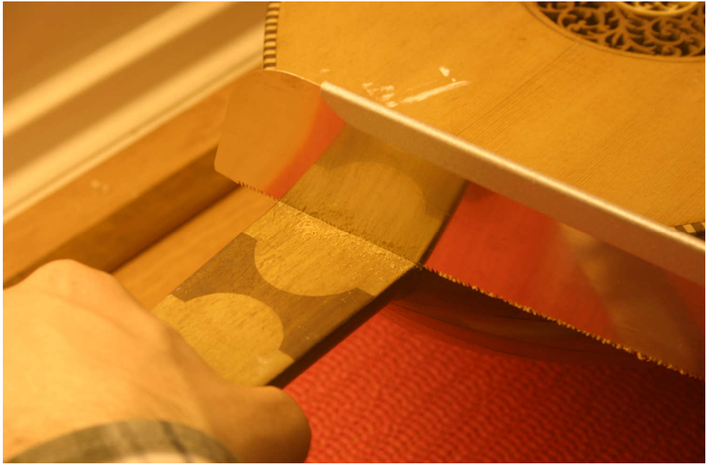
Şekil 3.33 Sapın kısmen kesilmesi
