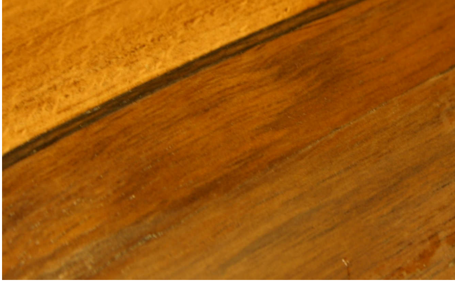
Şekil 3.29 Yapıştırırmadan sonra çatlak dilim
