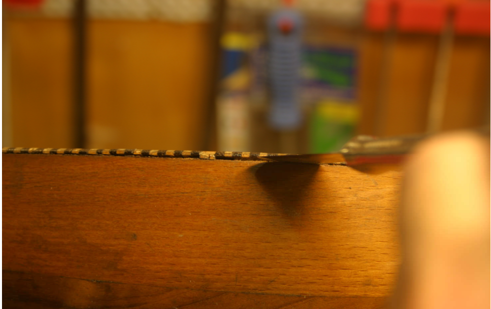
Şekil 3.8 Kenar filetolarının çıkarılması
