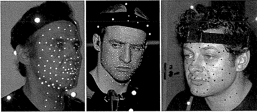
ŞEKİL 3.51 : Facial Motion Capture sisteminde, işaretleme üzerine örneklemeler
