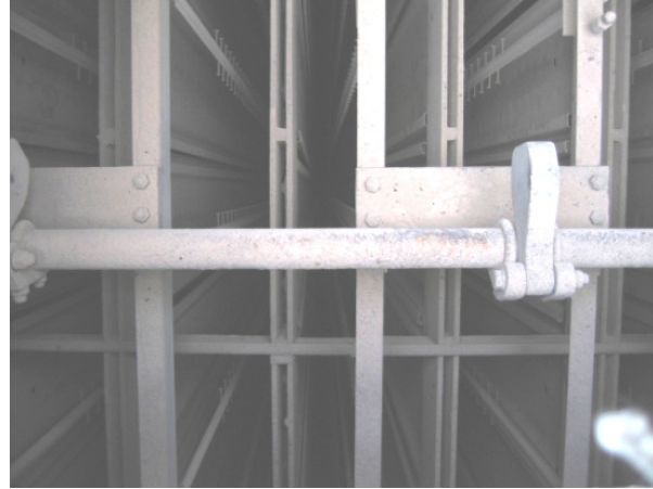
Şekil 2.23 : Korona elektrotu çekikleme sistemi.
