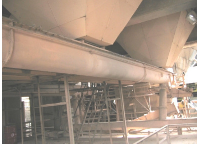
Şekil 2.24 : Elektrostatik filtre altı helezon sistemi.
