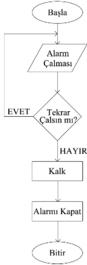
Şekil 3.15 : Bir saatin çalışmasını gösteren algoritmik akış diagramı (Çıltık, 2008)
