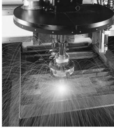
Şekil 3.32 : Plazma yay kesim yöntemi ( www.fab.cba.mit.edu )
