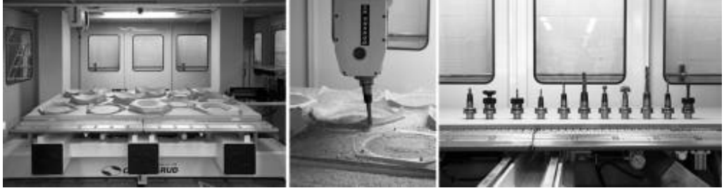
Şekil 3.88 : La Voute de LeFevre CNC kesim süreci ve kesim uçları ( http://www.architect.com )
