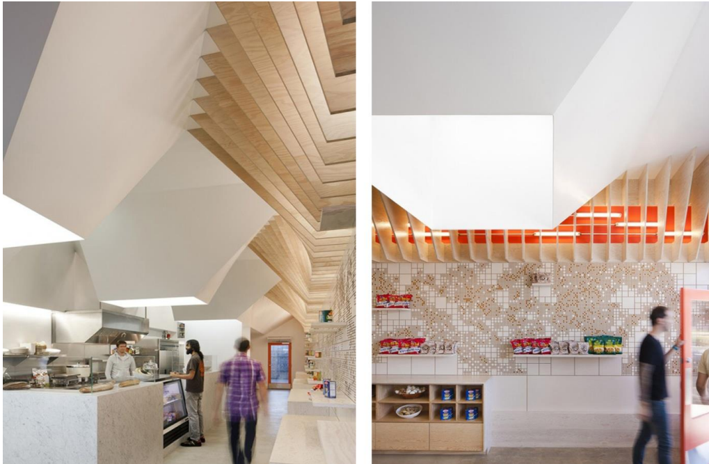
Şekil 3.49 : Freelandbuck tarafından tasarlanan Earl's Gourmet'in kesit alma yöntemiyle gerçekleştirilen tavan uygulaması ( http://www.suckerpunchdaily.com )
