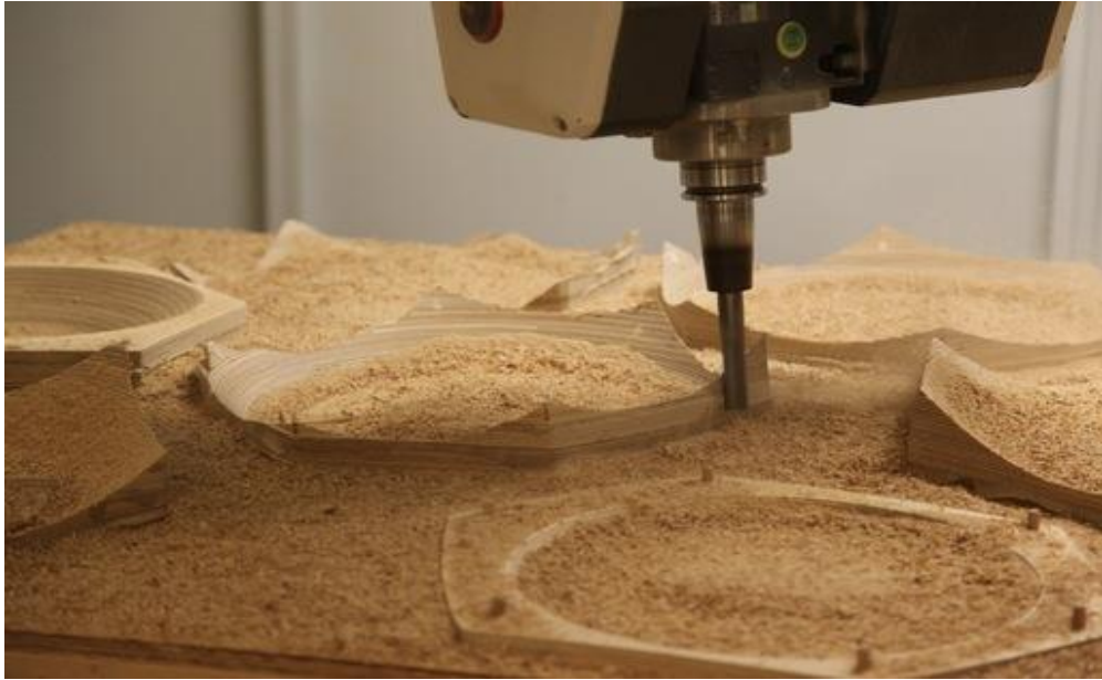
Şekil 3.87 : La Voute de LeFevre CNC kesim süreci ( http://www.archinect.com )
