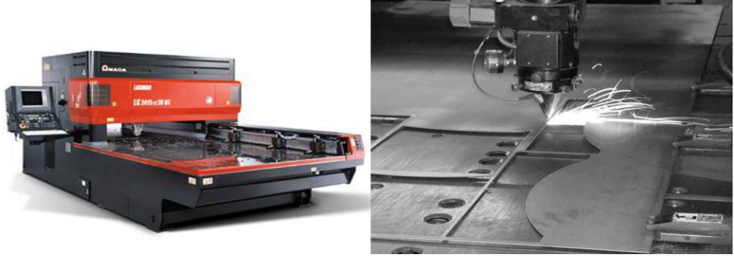
Şekil 3.27 : Lazer kesim makinası ve kesim süreci örneği ( www.stencilsunlimited.com )
