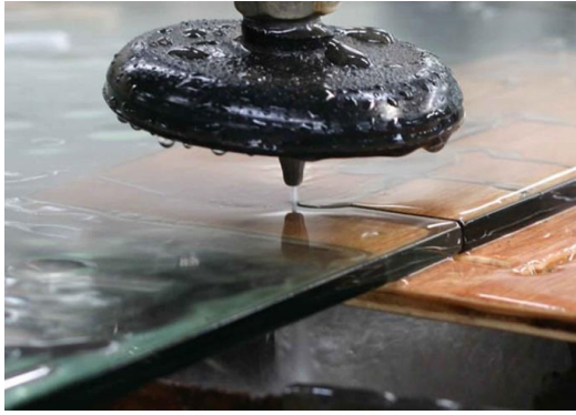
Şekil 3.29 : Su jeti kesim makinasının kesim süreci ( www.commonswikimedia.org ).
