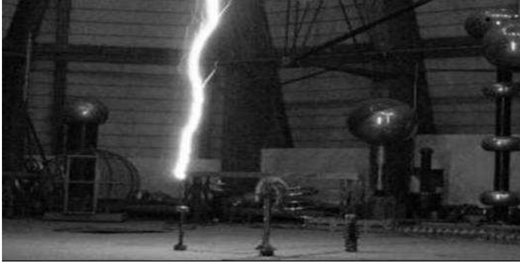
Şekil 4.9: Aynı elektrojeometrik koşullarda yakalama oranı deneyleri. (Atlama a) şeklinde YED 2' ye b) ve c) şekillerinde Franklin çubuğuna olmuştur.)
