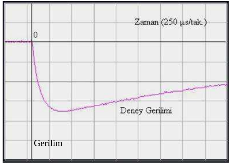
Şekil 4.4: Franklin çubuğu için örnek %50 deney gerilimi şekli.
