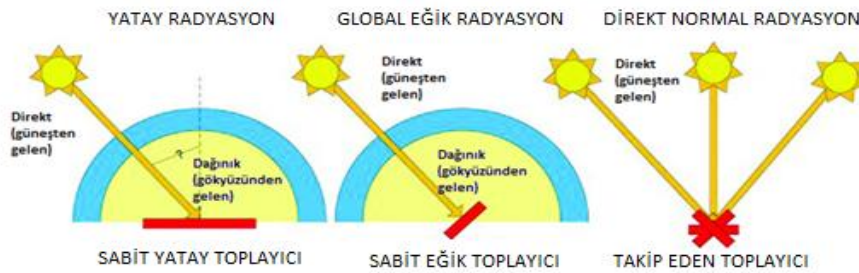
Şekil 1.4 : Sabit yatay, eğik ve takip eden toplayıcı türleri.
