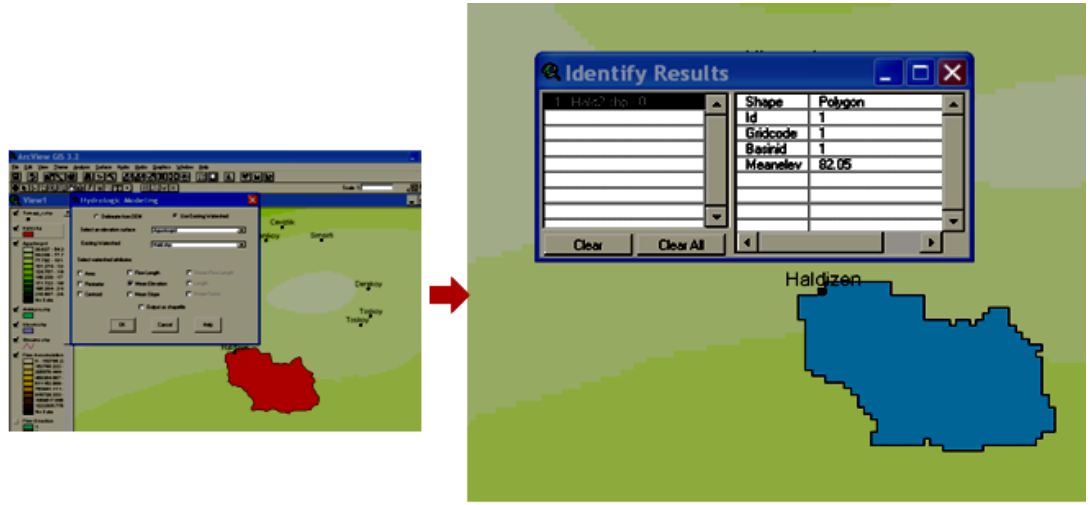
Şekil 3.24: Oluşturulan AGİ su toplama havzasının ağustos ayı eşyağış haritası kullanılarak ağustos ayı için ortalama yağış yüksekliğinin Hydrologic Modelling modülü kullanılarak hesaplanması ve gösterilmesi.
