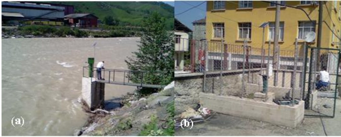
Şekil 3.3: GPS ile konumları tespit edilen istasyonlar (a) Akım Gözlem İstasyonu (b) Yağış İstasyonu
