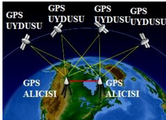
Şekil 3.1: Statik GPS ölçüm şeması.
