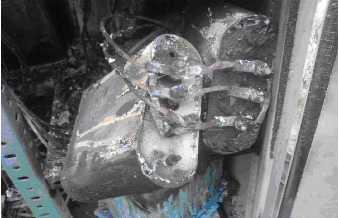
Şekil 5.1: Şiddetli Bir Patlamadan Hasar Görmüş Klasik Tip Kondansatörler
