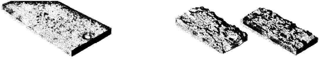
Şekil 4.16. 7150-T7751 levha alaşımı (solda) ve 7150-T6X alaşımları (sağda); kalınlık 0.75 in ( 19.05 mm ) olup 7150-TX alaşımlarında ileri derecede soyulma oluştuğu görülmektedir.
