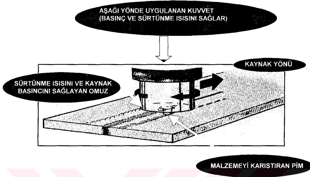
Şekil 5.7. Sürtünme karıştırma kaynağının şematik gösterimi
