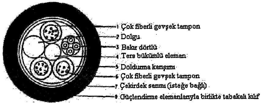
Şekil 8.6. Bir Bakır Dörtlüsü Olan Optik Fiberli Telekomünikasyon Kablosu
