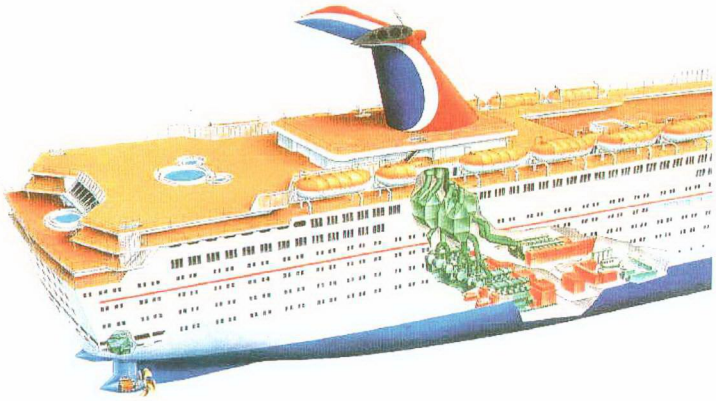
Şekil 2.5 Yolcu gemisine ait Azipod sürücü
