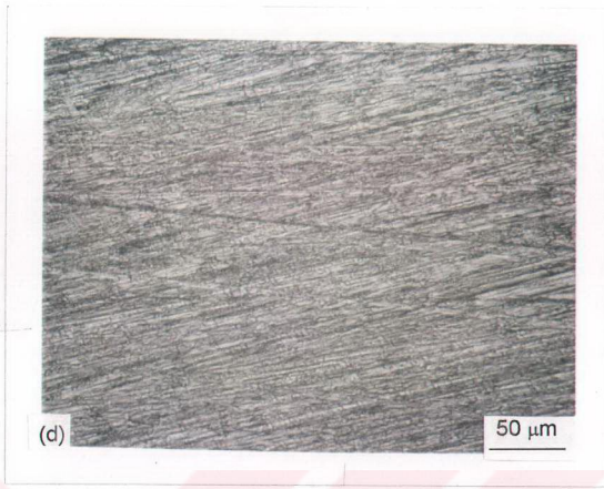
Şekil A.34. MAgPP düzenleyici katkılı polimer karışımlarının takım çeliği karşı yüzeyde kayma hareketi sırasında esas çalışma bölgesinde transfer film oluşumunu inceleyen test sonunda çekilen optik mikrofotografılar: (a) %20 PA6- %80 HDPE, (b) %40 PA6- %60 HDPE, (c) %60 PA6- %40 HDPE, (d) %80 PA6- %20 HDPE.
