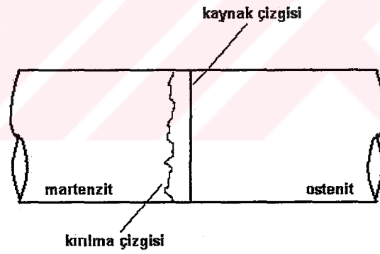
Şekil 3.35: A61 Numunesi Kırılma Bölgesinin Şematik Gösterimi
