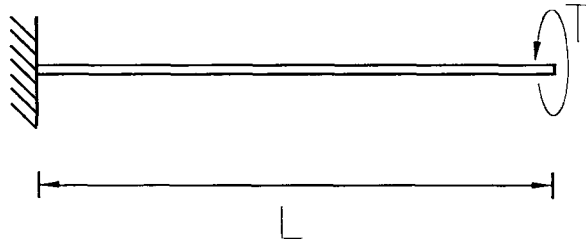
Şekil 2.16 Burulma momentinin etkisindeki ankastre bağlı çubuk
