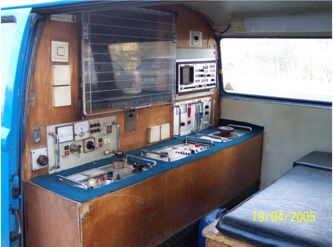
Şekil 2.22: BEDAŞ Test – Ölçü aracı Kumanda Masası.
