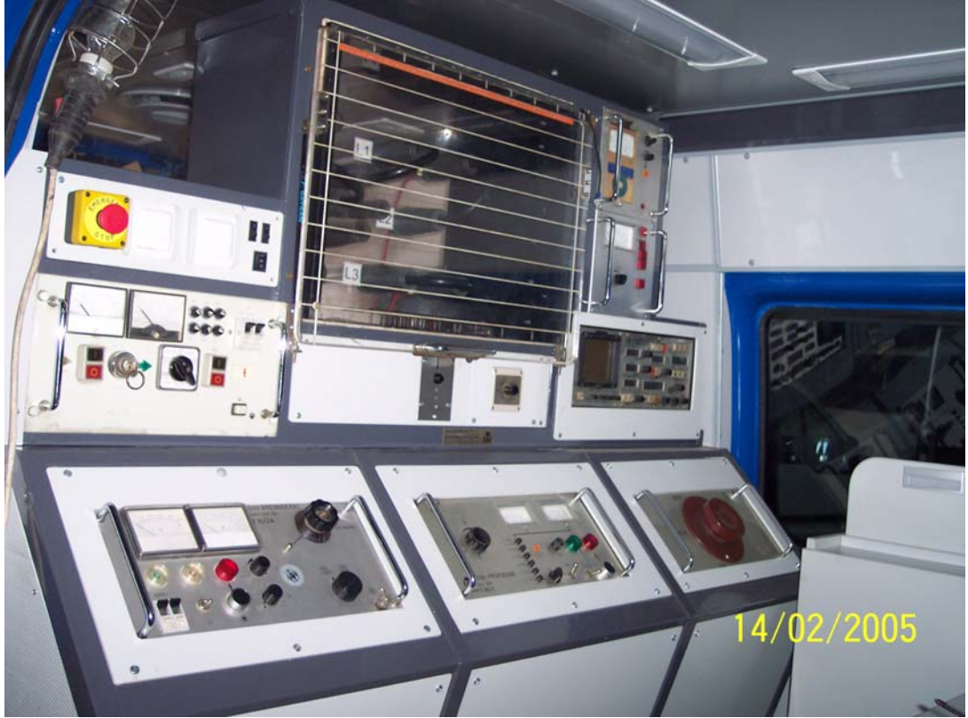
Şekil 2.23: BEDAŞ Yeni Tip Test – Ölçü Aracı Kumanda Masası.
