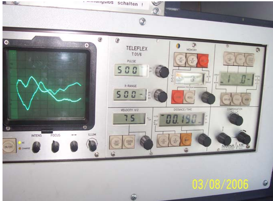
Şekil 3.6: 1. Deneyde Arıza Noktası ve Mesafesinin Teleflex Cihazında Görüntüsü.
