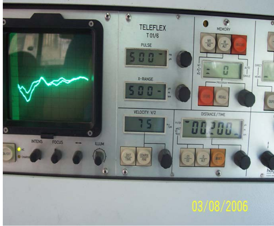
Şekil 3.10: 3. Deneyde Arıza Noktası ve Mesafesinin Teleflex Cihazında Görüntüsü.
