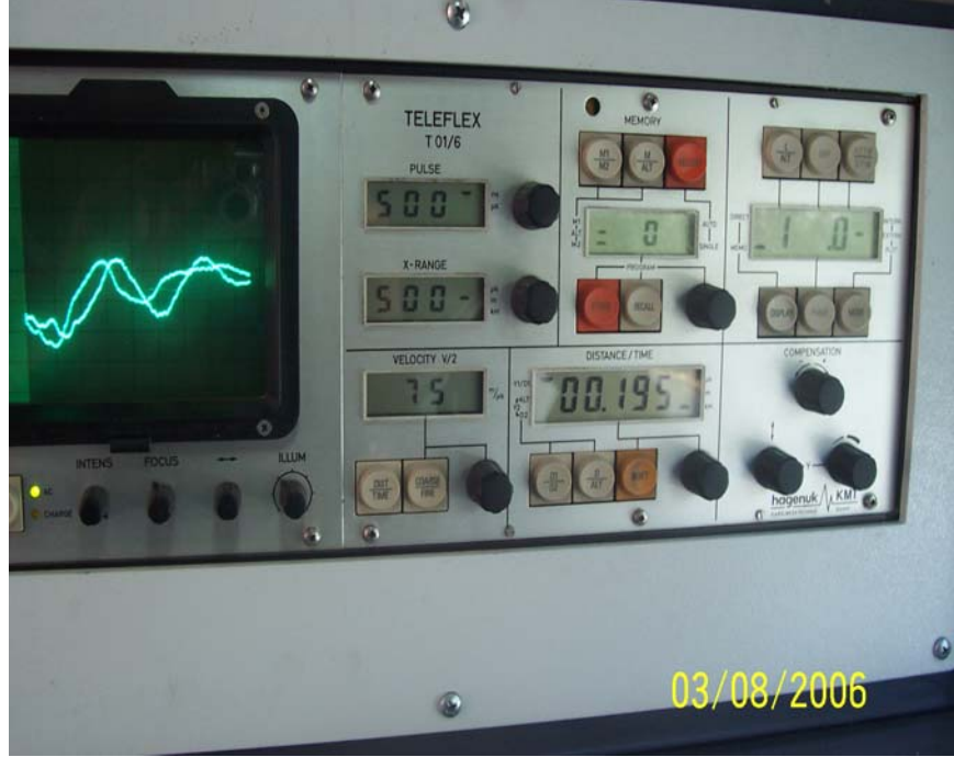
Şekil 3.8: 2. Deneyde Arıza Noktası ve Mesafesinin Teleflex Cihazında Görüntüsü.
