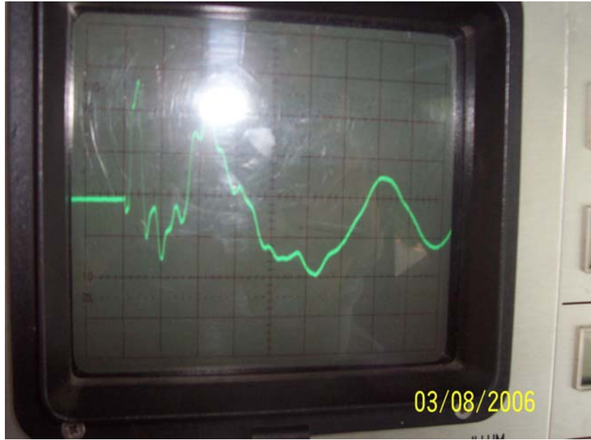
Şekil 3.4: Kablonun Sağlam Damarının Yansıyan Dalga Görüntüsü.
