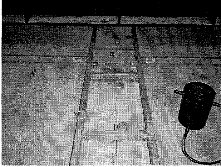
Şekil 5.28 P4 Plağının Üst Yüzeyinin Kırılma Sonrası Görünümü
