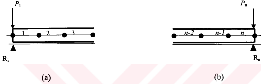
Şekil 5.16. Sınır düğüm noktalarında basit mesnetler: (a) sol uç (b) sağ uç
