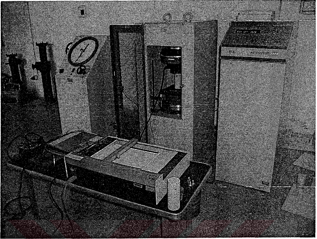
Şekil 4.1 Tek eksenli basınç ve statik elastik deneylerinin yapıldığı pres
