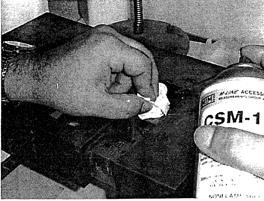
Şekil 3.4 Yüzeydeki kirli tabakaların yağ çözücülerle arındırılması işlemi
