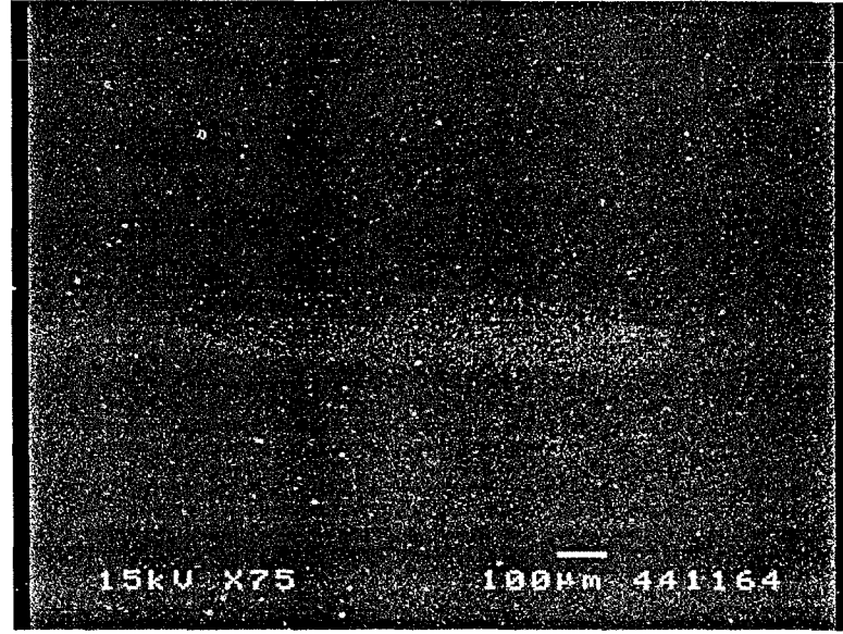
Şekil 8.24. Fırçalanmış CrN kaplamalı diskte oluşan aşınma izinin genel görüntüsü (Oda sıcaklığı, 10N)
