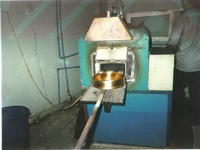
Şekil 4.6 Gaz Atmosferli Permaksan marka (yerli) Tav Fırını
