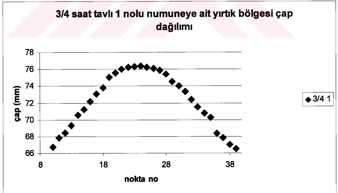
Şekil 4-72 ¾ saat tavlı 1 numaralı numune için gerçekleşen yırtık çap dağılımı
