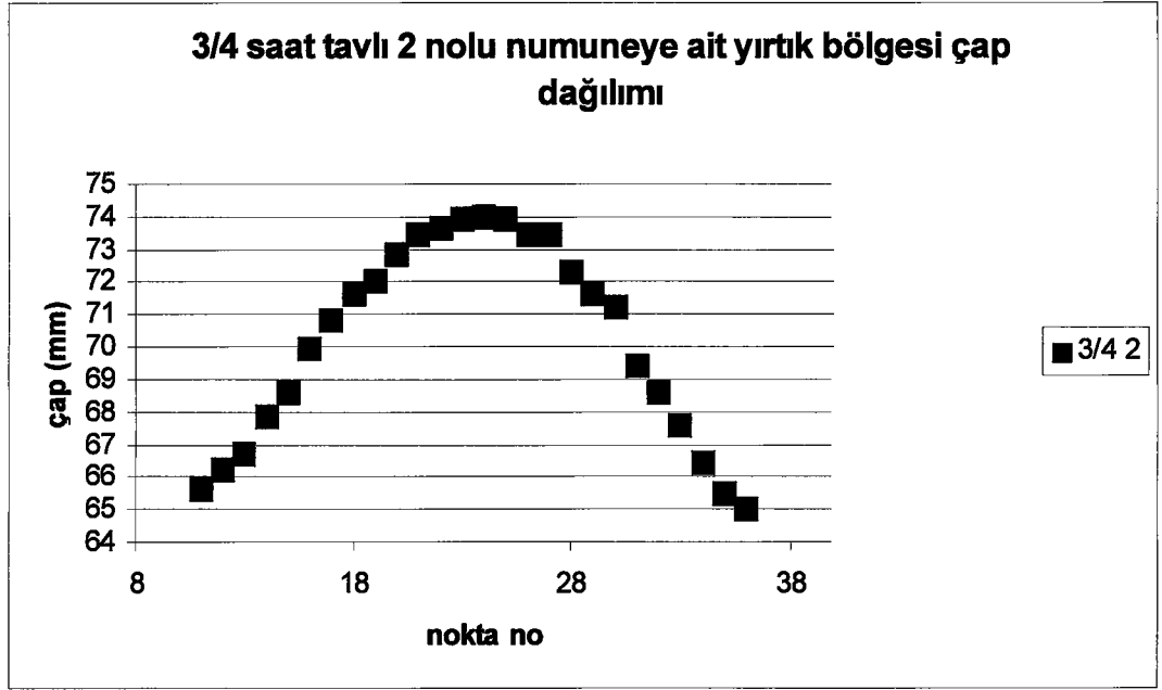
Şekil 4-73 3/4 saat tavlı 2 numaralı numune için gerçekleşen yırtık çap dağılımı
