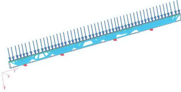
Şekil 6.9 Düzgün yaylı yük altında yan profilin optimum topolojisi.
