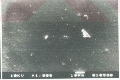
Şekil A.100 MoS 2 katkılı PA 66' nın oda sıcaklığı (a) ve yüksek sıcaklıkta (b) aşınmış yüzeylerinin tarayıcı elektron mikroskobu altındaki görüntüşleri
