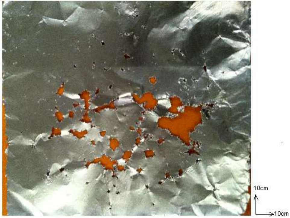
Şekil 5.9 : 50°C’de 40 kHz sabit frekansta çalışma.
