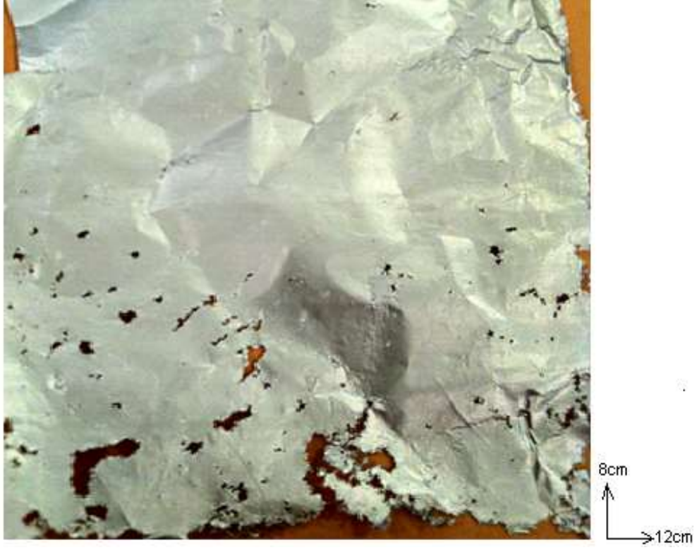
Şekil 5.21 : Folyo kazana dik ve 40 kHz sabit frekansta çalışma.
