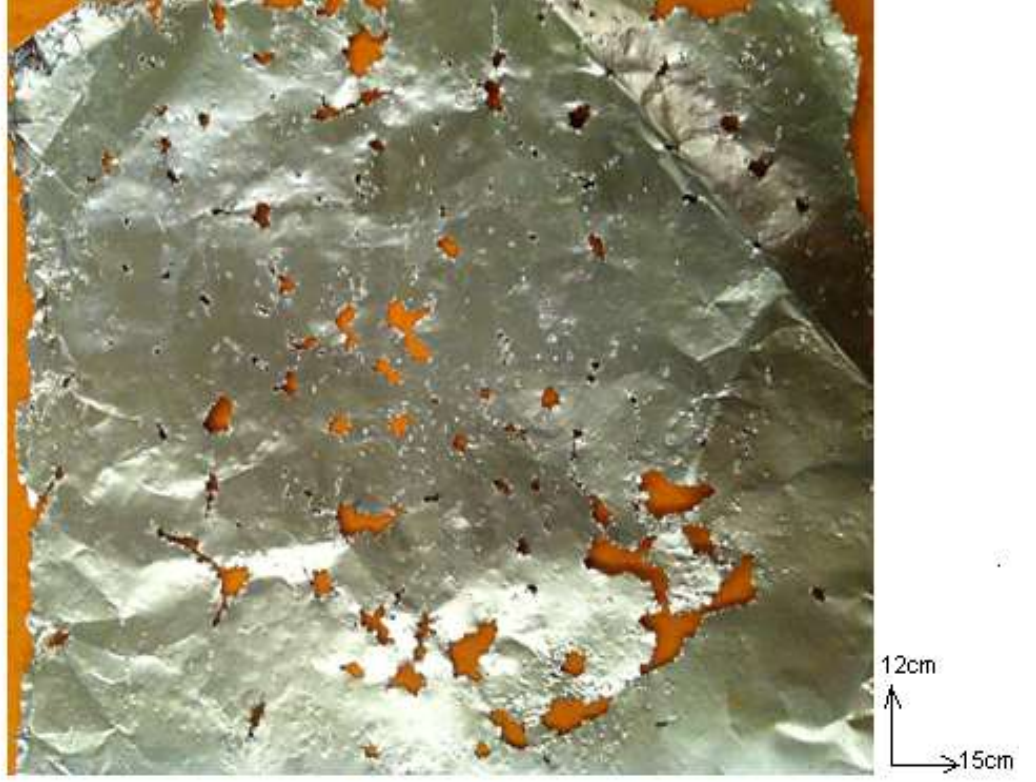
Şekil 5.19 : Folyo kazana dik ve 38 kHz sabit frekansta çalışma.
