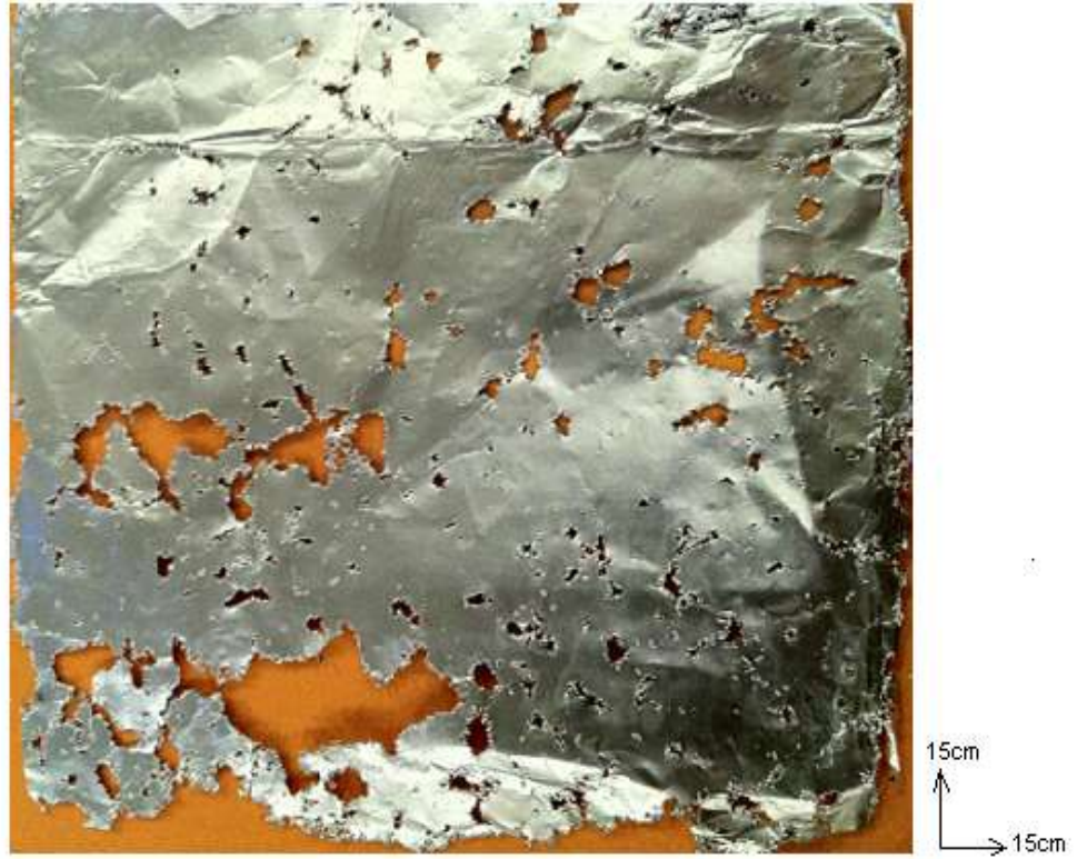
Şekil 5.11 : 70°C’de 40 kHz sabit frekansta çalışma.
