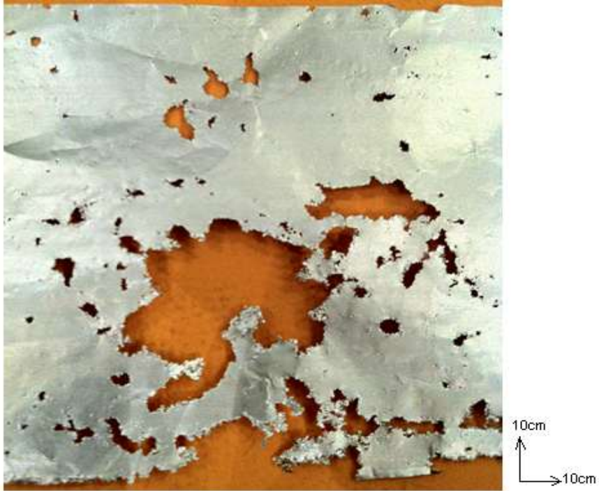
Şekil 5.13 : Güç Seviyesi 5 ve 39 kHz sabit frekansta çalışma.
