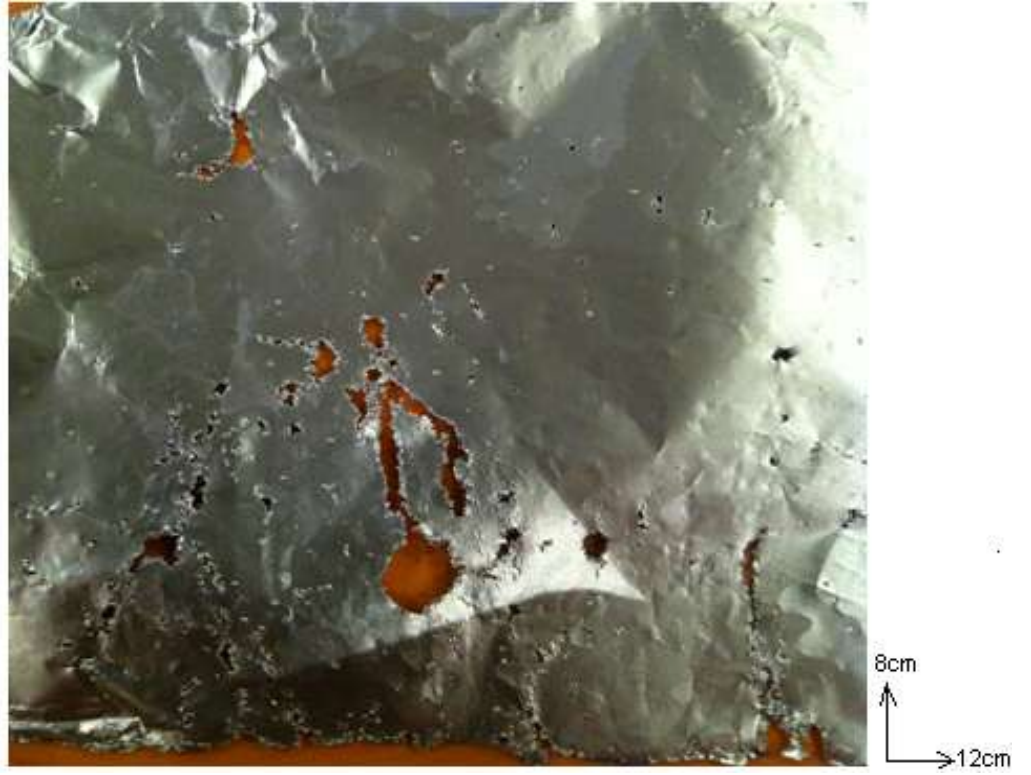
Şekil 5.20 : Folyo kazana dik ve 39 kHz sabit frekansta çalışma.
