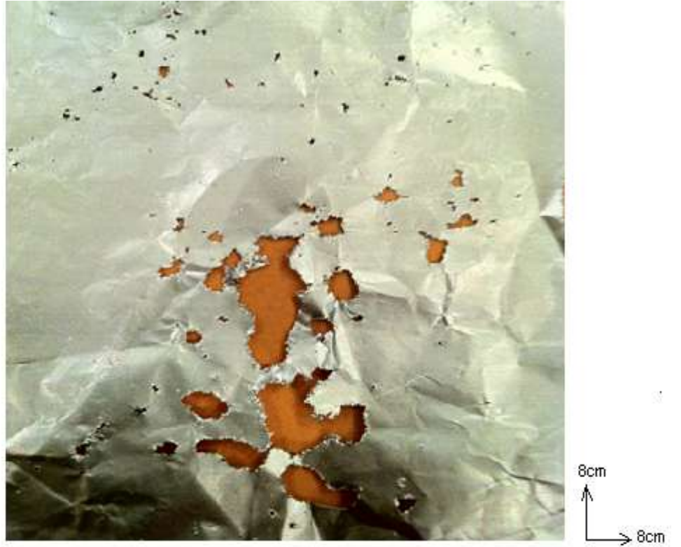
Şekil 5.24 : Folyo kazana dik, 50°C’de 38 kHz sabit frekansta çalışma.
