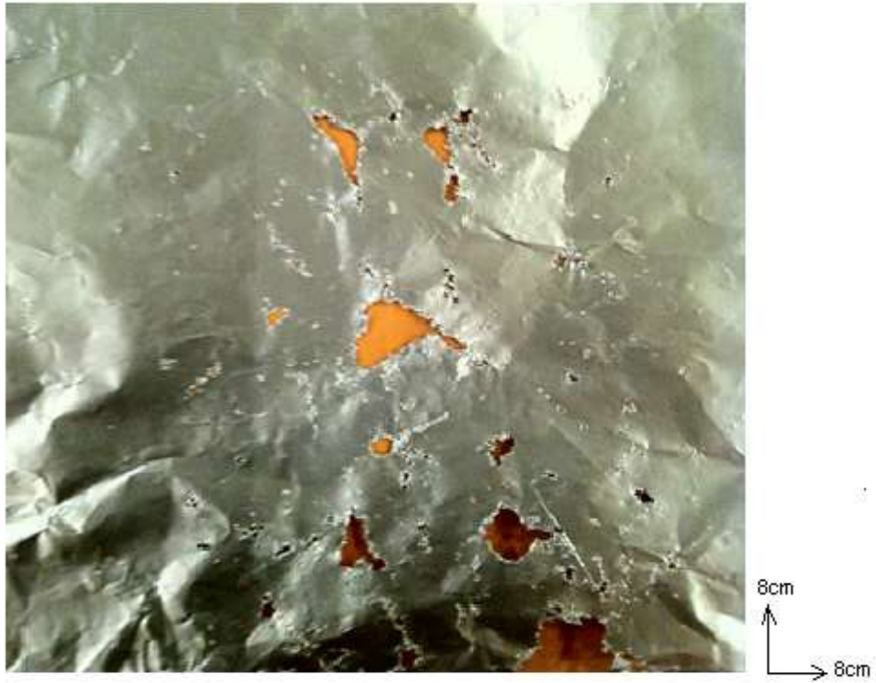
Şekil 5.22 : Folyo kazana dik, 20°C’de 38 kHz sabit frekansta çalışma.
