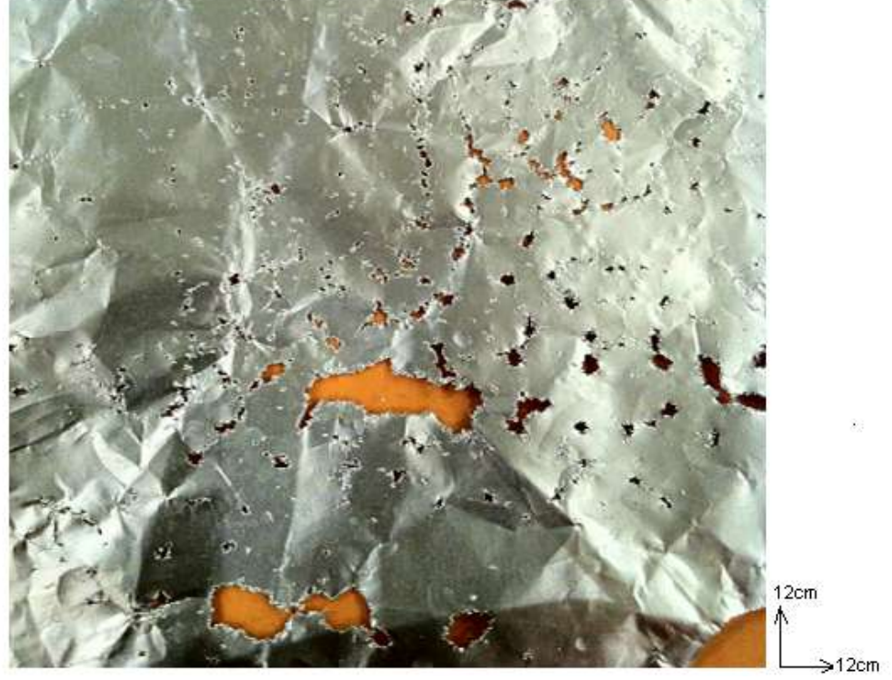
Şekil 5.7 : 20°C'de 40 kHz sabit frekansta çalışma.
