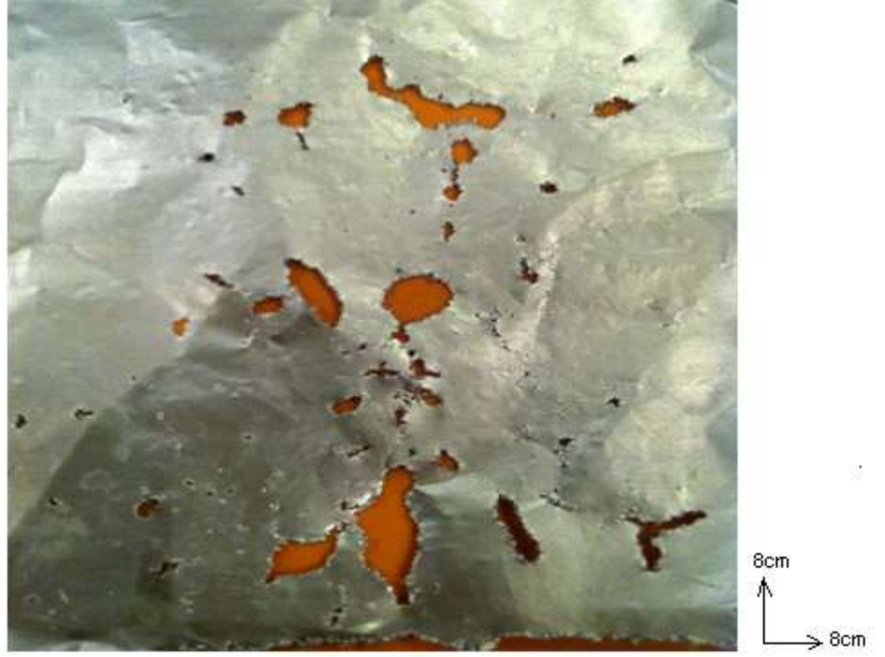
Şekil 5.23 : Folyo kazana dik, 30°C’de 38 kHz sabit frekansta çalışma.
