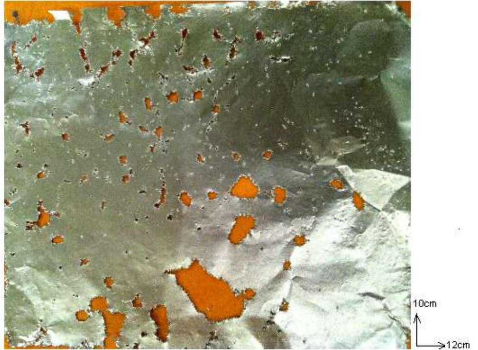
Şekil 5.8 : 30°C'de 40 kHz sabit frekansta çalışma.
