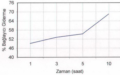
Şekil 7.5 180 °C'de yapılan bağlayıcı giderme işleminde süreye göre giderilen % bağlayıcı oranı
