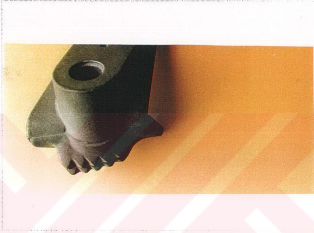
Şekil 4.6 Kalıp kayması hatası
