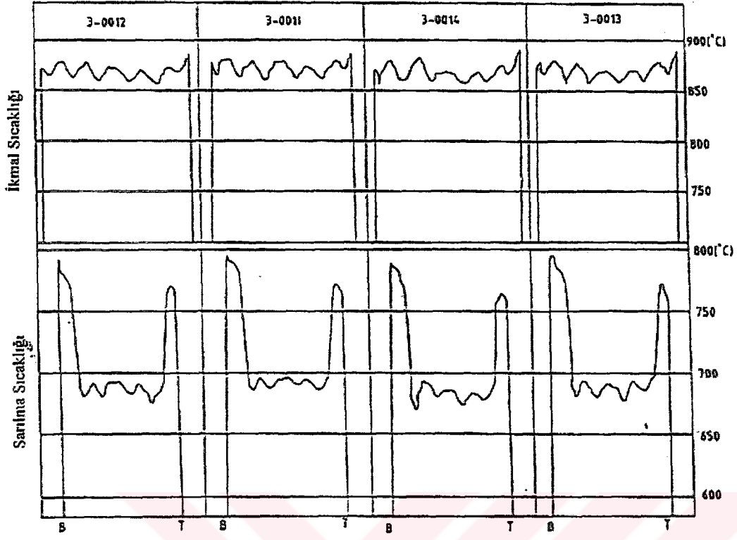
Şekil 4.7. NKK-Fukuyama Tesislerinde Uygulanan İkmal ve Sarılma Sıcaklıkları [12].
