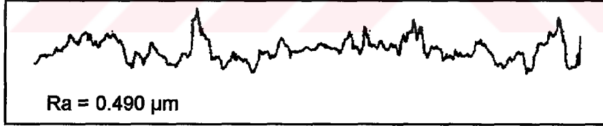
Şekil 7.145 TiN kaplı (TiN) numunenin yüzey pürüzlülük profili.
