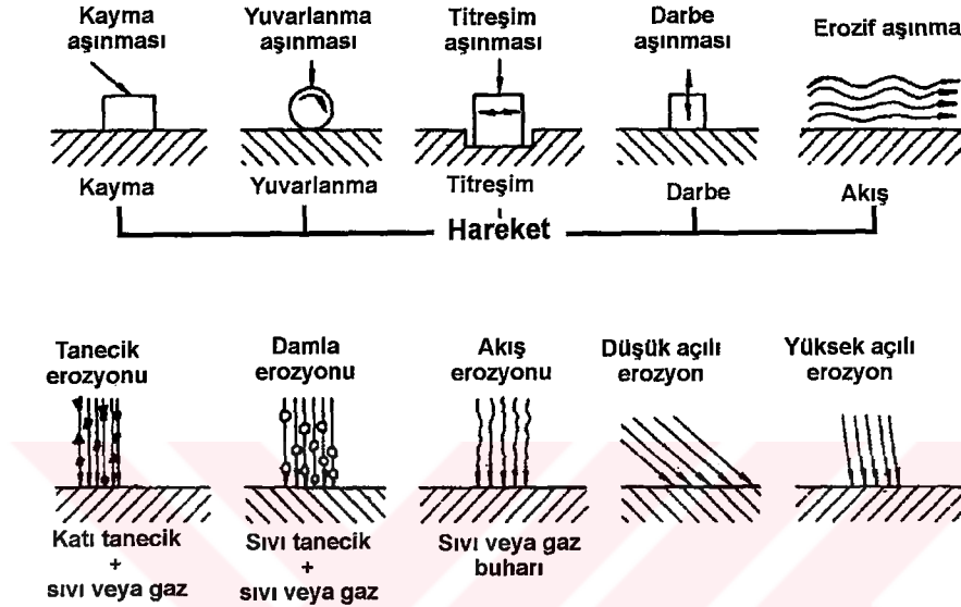
Şekil 2.3 Aşındırma türleri ile aşınma işlemlerinin sınıflandırılması[10, s 83].
