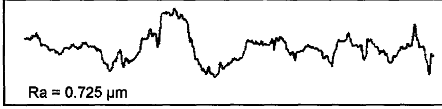
Şekil 7.143 Plazma (iyon) nitrürlenmiş (IN24) numunenin yüzey pürüzlülük profili.
