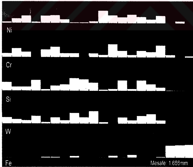
Şekil 7.118 2F2 numunesinde hat EDX analizi.
