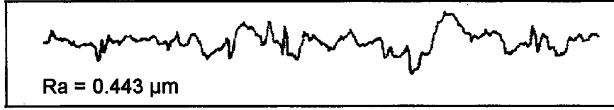
Şekil 7.139 Plazma (iyon) nitrürlenmiş (IN1/2) numunenin yüzey pürüzlülük profili.
