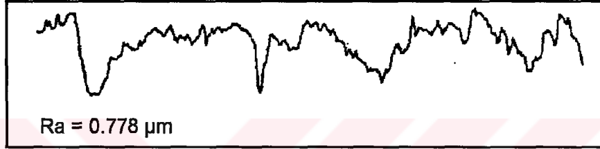
Şekil 7.144 Plazma (iyon) nitrürlenmiş (IN48) numunenin yüzey pürüzlülük profili.
