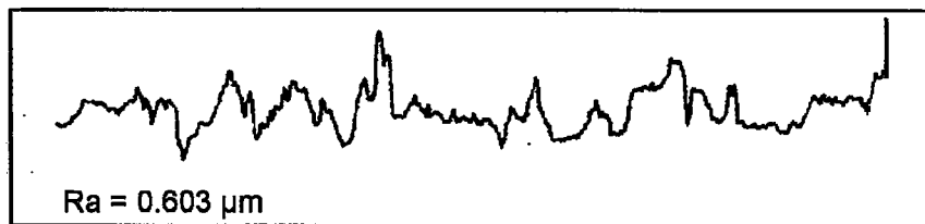
Şekil 7.138 Gaz ortamında nitrürlenmiş (GN12) numunenin yüzey pürüzlülük profili.
