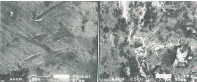
Şekil 7.106 PVD ile Titanyum Nitrid (TiN) numuneye ait SEM fotoğrafı.
