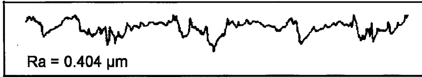
Şekil 7.140 Plazma (iyon) nitrürlenmiş (IN1) numunenin yüzey pürüzlülük profili.
