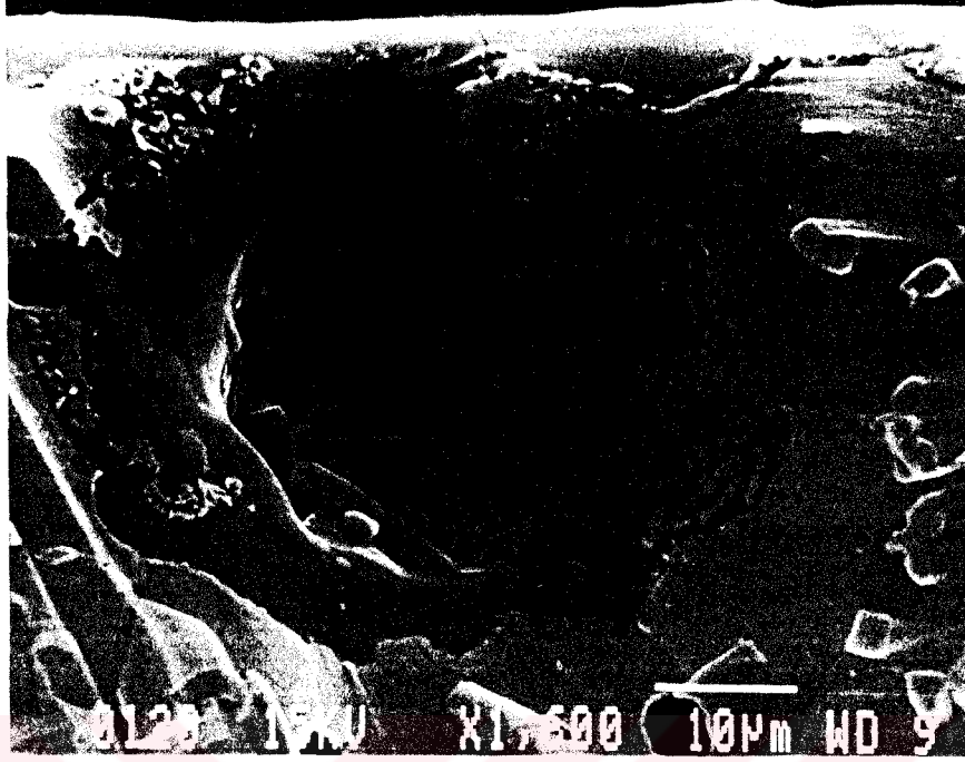
Şekil 4.54 1400°C’de oksidasyon sonrası numune yüzeyini gösteren SEM-SEI mikrografi.
