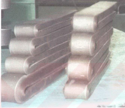
Şekil 7.9 180° katlanmış X60 çeliğine ait numuneler.
