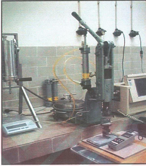
Şekil 3.12. Mark-10 Kuvvet ölçer modifikasyonu ile BOS kesme gerilmesi ölçüm cihazı
